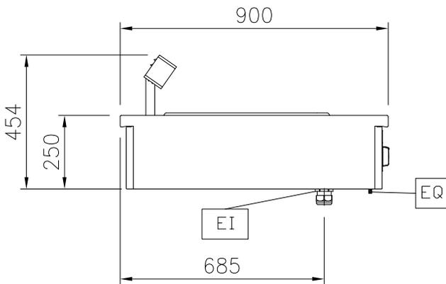
EI = Conexión eléctrica (energía)
